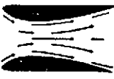
DEN FÖRTRÄNGDA LUFTSTRÖM som visas här och som bildas av två motstående flygplansvingar, ger samma resultat som det förträngda röret ovan: luften som rör sig mellan vingarna accelererar, och fartökningen åker på ett lägre tryck mellan de båda välvda ytor.
