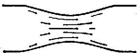
BERNOULLIS PRINCIP som förklarar hur lyftkraften skapas av ett flygplansvingar. Illustreras i dessa tre schematiska teckningar. En vätska, som pressas igenom en förträngning i ett rör (ovan), rinner snabbare samtidigt som det tryck den utövar mot rören väggar minskar.
