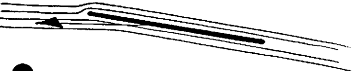
Lyftkraft åstadkommes genom att vingen - i detta fall en plan platta med anfallsvinkel - accelererar luften nedåt. Detta ger en reaktionskraft (motkraft) uppåt (=lyftkraft).
